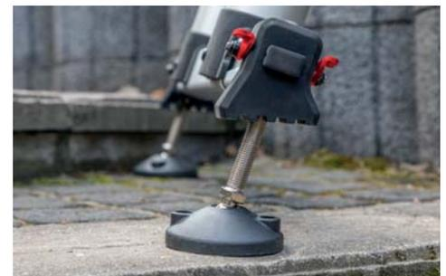
Mittels den roten Hebeln wird der Höhenausgleich stufenlos verschoben. Feinjustierung kann mittels Schraubrotation vorgenommen werden, wenn nötig. Kugelgelenke ermöglichen korrekten Anstellwinkel und gleichen Bodenunebenheiten aus.
